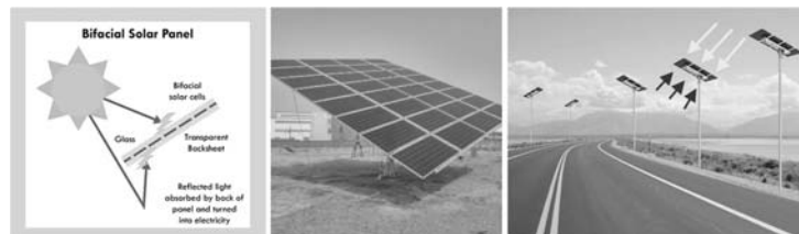
Figura Nr.9. - Panele diellore që shfrytëzojnë rrezatimin diellor në të dy anët.
