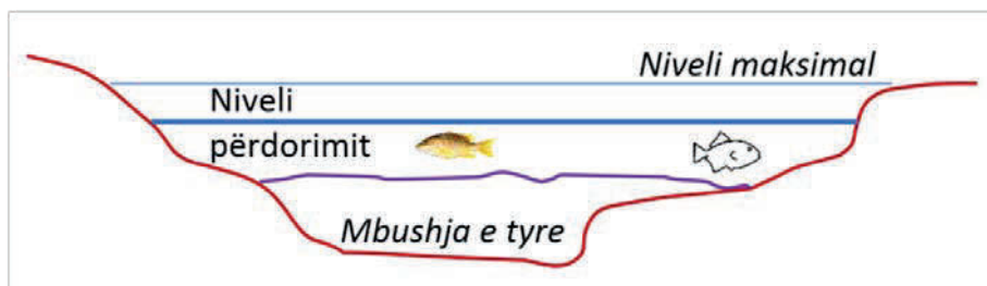
Figura nr. 2. Paraqitje skematike se ç'ndodh me rezervuarët kur ato nuk monitorohen dhe mirë administrohen në përputhje me standardet teknike.
