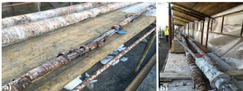
Figura 10: Shufrat e parandërjes, të nxjerra dhe të analizuar.
