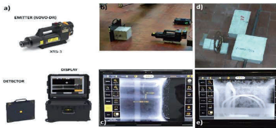
Figura 16: Pajisja me rreze X (a); imazhi i skanuar (b) i ekzemplarit (c); imazhi i skanuar (d) i ekzemplarit (e).
