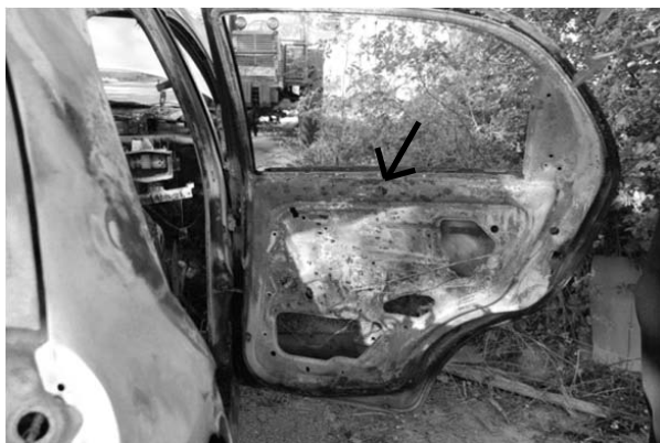
Fig. 7 Pamje e pjesës së brendshme të derës së pasme krahu i djathtë i automjetit, ku me shigjetë tregohen zonat më të djegura të saj.
