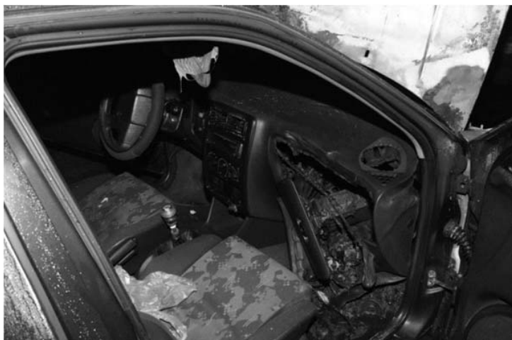
Fig. 5 Pamje e ambientit të brendshëm të automjetit ku vërehet pjesa e kroskotit e dëmtuar si pasojë e kalimit të zjarrit nga kafazi i motorit në kabinë.
