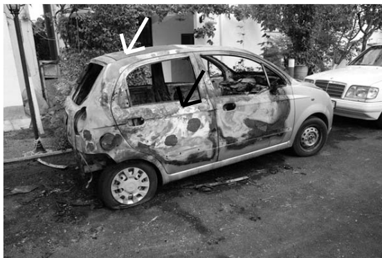
Fig. 6 Pamje e automjetit pozuar nga pjesa anësore e djathtë, ku me shigjeta tregohen zonat më të djegura në automjet.
